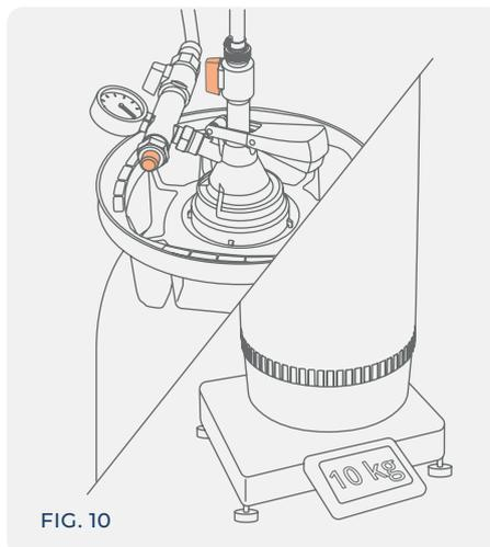
Aprire il rubinetto prodotto per iniziare il riempimento e agire sul regolatore di contro-pressione per impostare e/o variare la velocità di riempimento.
