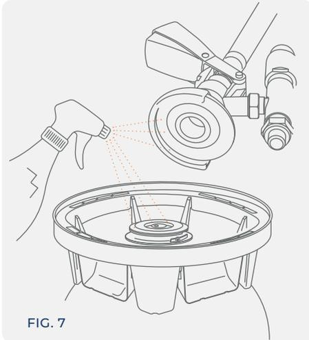
Smontare il kit di riempimento PolyKeg® e sanificare le parti nella figura e nella sezione “Istruzioni per la sanificazione”.
