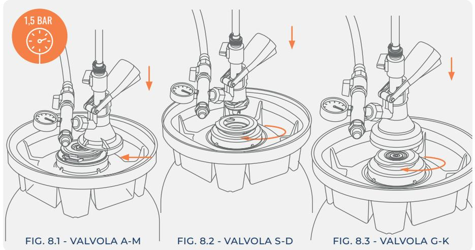
Collegare correttamente la testa di riempimento alla valvola, abbassare la leva e verificare la pressione interna del fusto.
